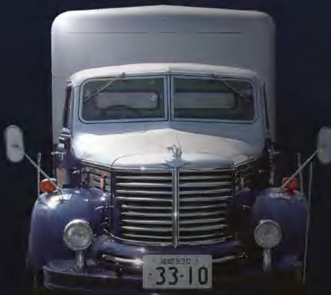
国産第一号機械式冷凍車(矢野式冷凍車)
