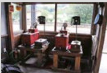
▲油須原駅にあったタブレット閉塞機です。色々操作の手順があって、基本的には何があっても事故が起きないような構造になっていました。(吉村 蒼空(75回生)撮影)
